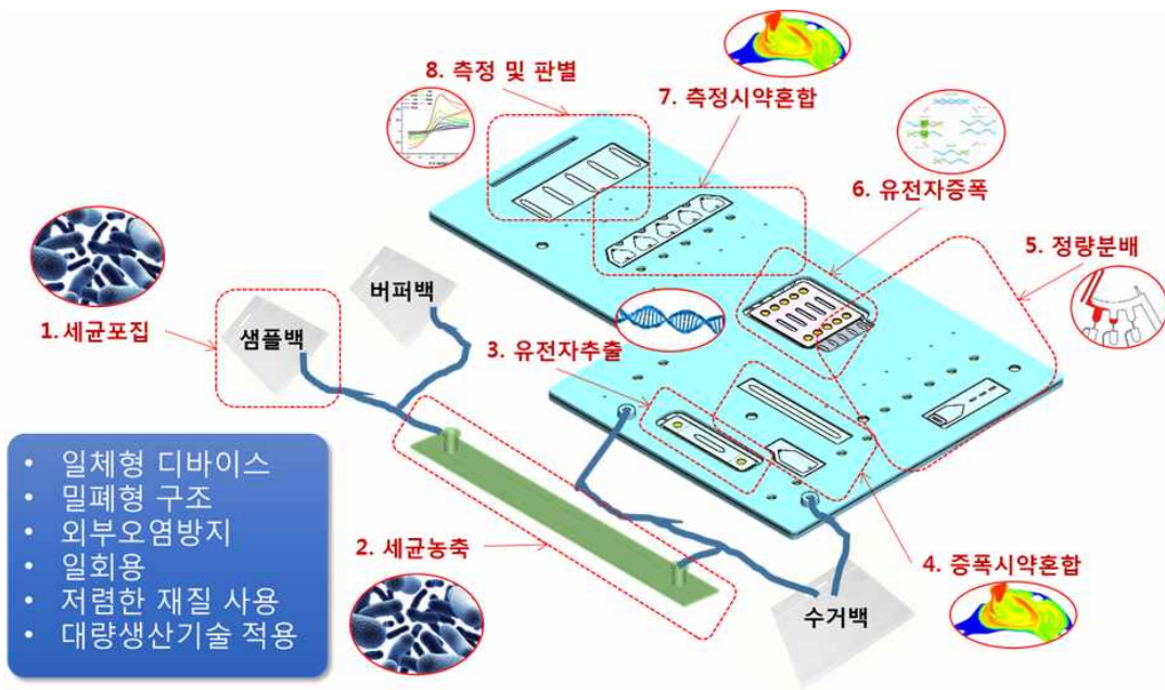
<8단계의 식중독균 유전자 판별 과정이 하나로 집약된 일체형 랩온어칩 구성도>
