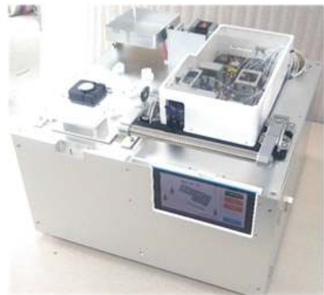
<식중독균 판별용 일체형 랩온어칩과 전자동 판별 시스템 시제품>
